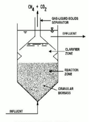
UPFLOW ANAEROBIC SLUDGE BLANKET REACTOR
